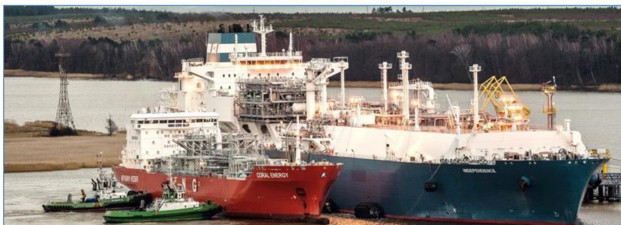
Figure 10 Berthing of the LNG bunker ship onto a LNG FSRU ship
