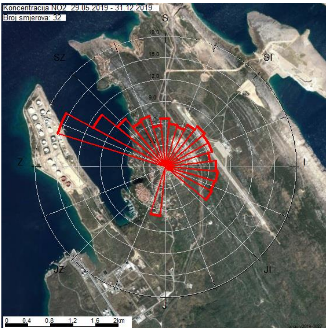
Slika 4.2.12: Prikaz srednjih imisijskih koncentracija NO 2 u odnosu na smjer vjetra na lokaciji Pušća 117 (Općina Omišalj) za razdoblje mjerenja 29.5.- 31.12.2019. (u µg/m 3 )
