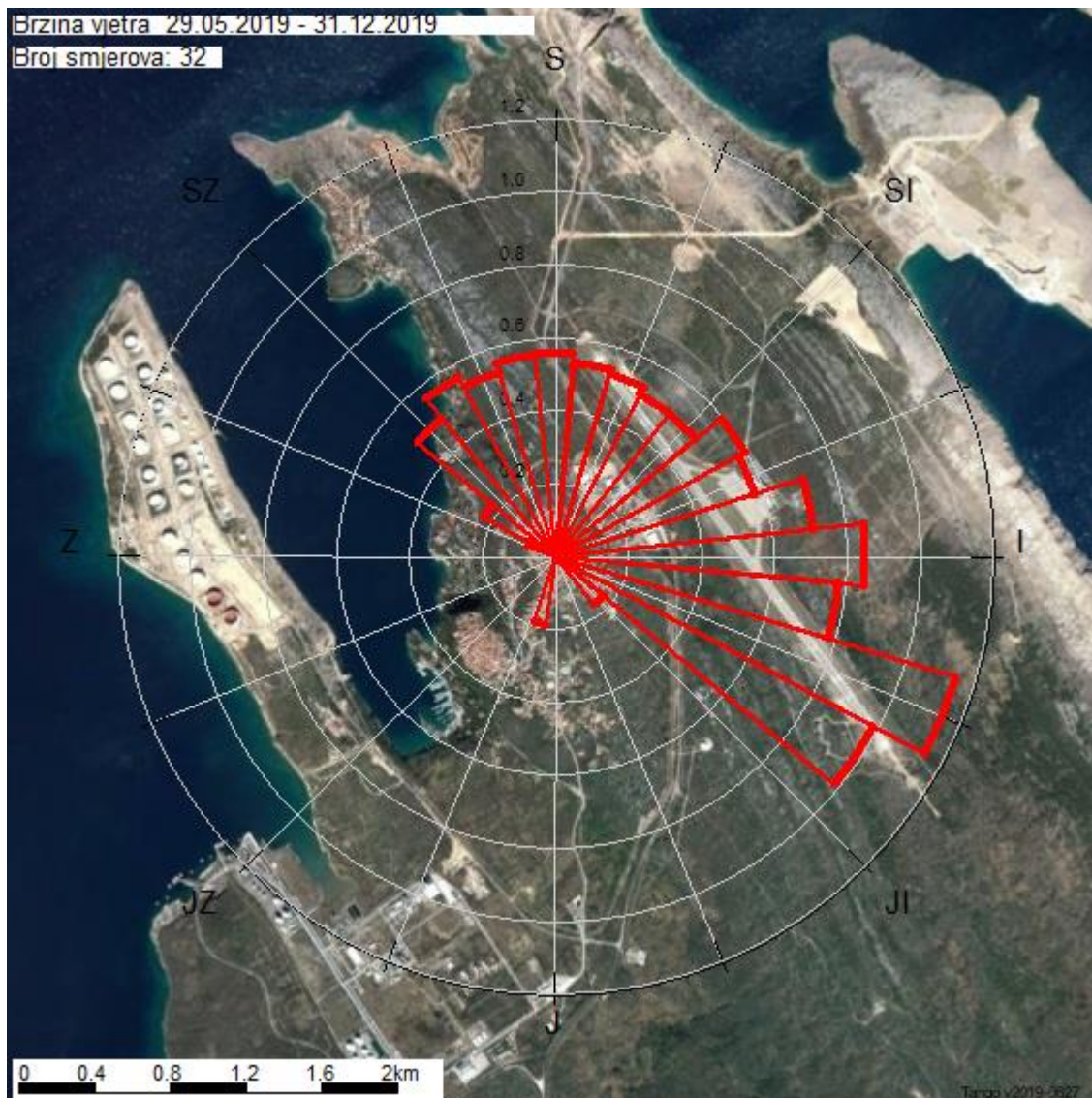
Slika 4.1.2: Prikaz usrednjene 60-minutne brzine vjetra na lokaciji Pušća 117 (Općina Omišalj) za razdoblje mjerenja 29.5.- 31.12.2019.
