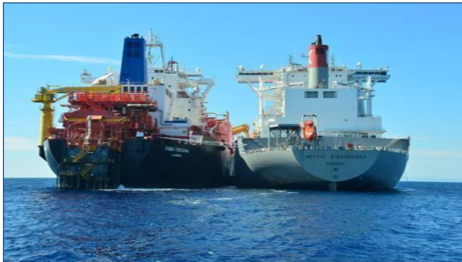
Slika 29 Prekrcaj korištenjem prekrcajnih ruku u nezaštićenom području
