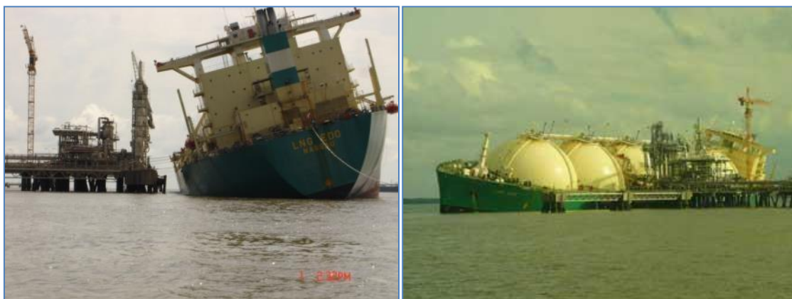
Slika 75 Nagruće broda LNG EDO uslijed nepravilnog balastiranja broda
