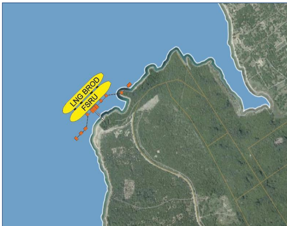
Slika 33 Shematski prikaz terminala s mjestom priveza FSRU broda
