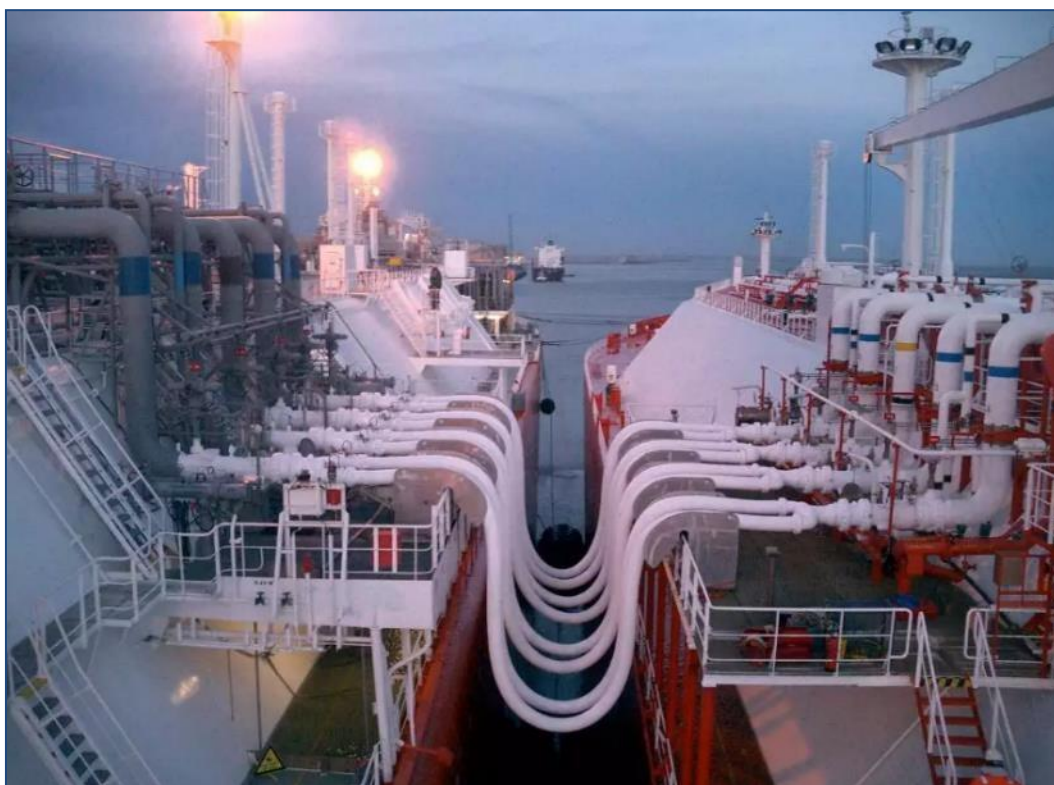
Slika 28 Prekrcaj korištenjem fleksibilnih cijevi
