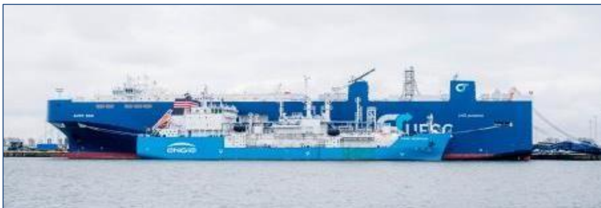
Slika 15 Brod „ENGIE ZEEBRUGGE“ - prvi namjenski LNG bunker brod (u radu od travnja 2017. godine)
