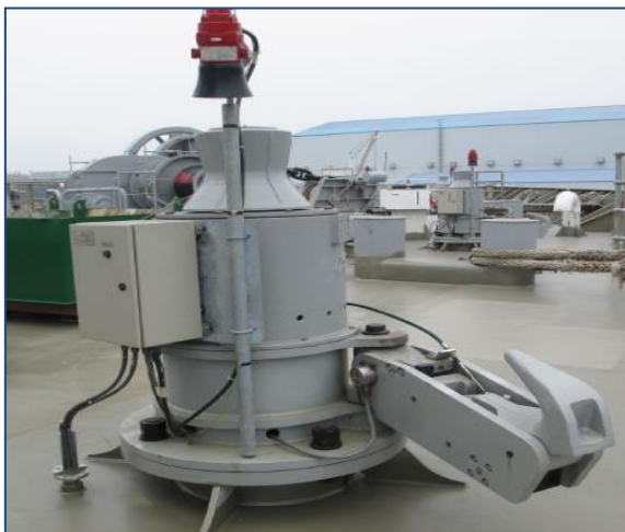
Slika 66 Brzo otpuštajuće kuke na FSRU brodu (jednostruke i dvostruke)
