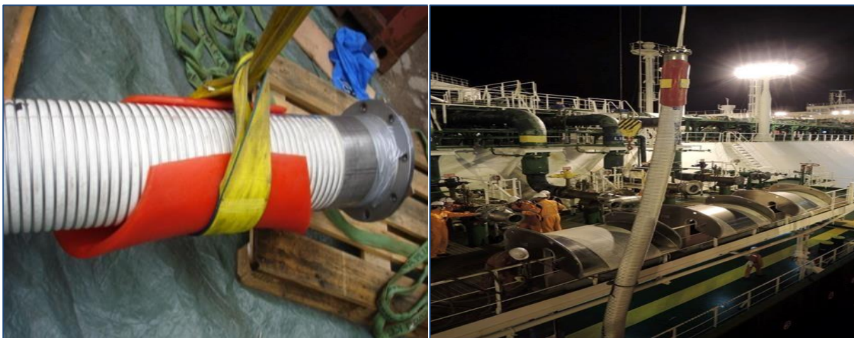
Slika 25 Rukovanje fleksibilnim cijevima i njihovo postavljanje u sedlo
