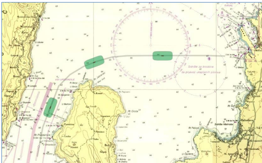
Slika 44 Preporučena domena LNG broda (zeleno) na uobičajenom plovidbenom putu prilaza
