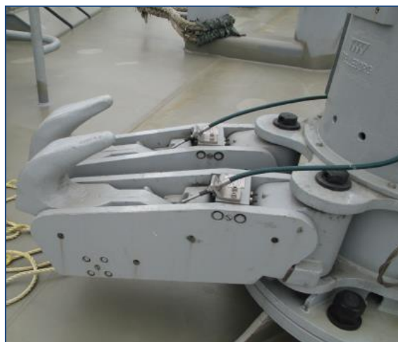
Slika 66 Brzo otpuštajuće kuke na FSRU brodu (jednostruke i dvostruke)
