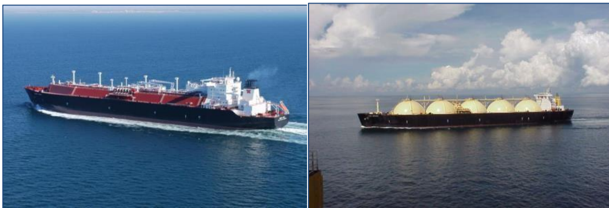
Slika 19 LNG brod sa membranskim (lijevo) i samonosivim tankovima (desno)
